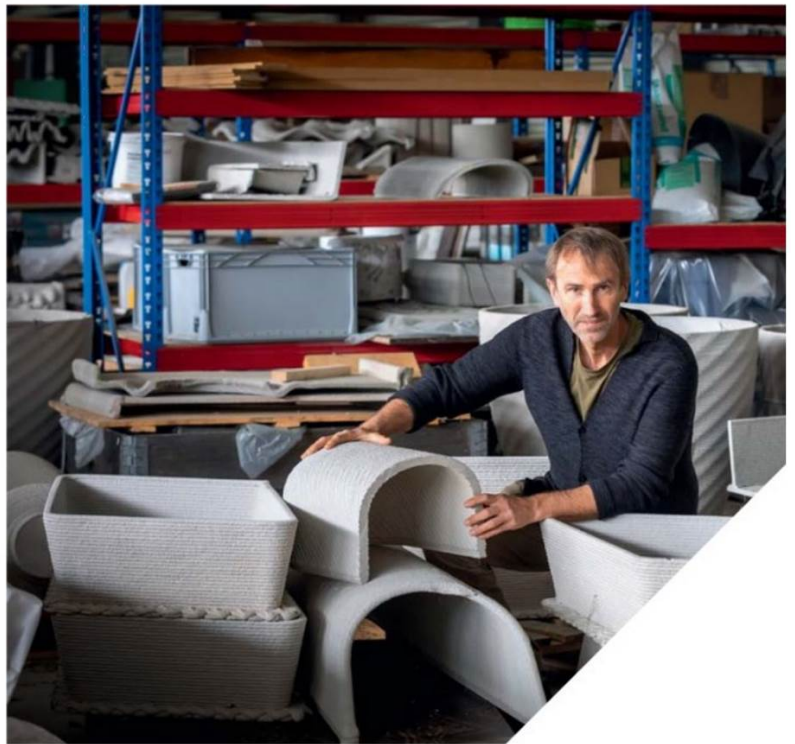
Leichter Bauen mit Beton: Andreas Trummer vom Institut für Tragwerksentwurf der TU Graz mit Bauteilen aus dem Beton-3D-Drucker, der Material und CO 2 spart
